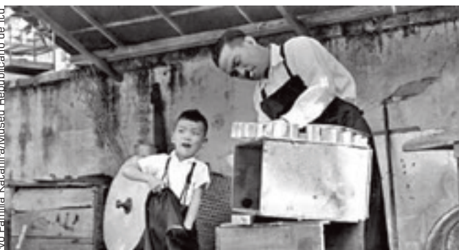
Ryochi, ladeado por Victor, aparece montando um tanque giratório para a lavagem química do papel fotográfico, processo que garantia a fixação duradoura da imagem
