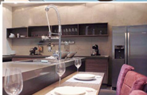
sai da parede). Uma boa dica no momento da instalação é observar a distância mínima de 30 centímetros de altura entre a cuba e a bica – garantindo espaço suficiente para o manuseio de louças, talheres e panelas durante a higienização. No caso de moradores que possuem utensílios como travessas e panelas muito grandes, o ideal é optar por um modelo de torneira com bica articulável, pois assim terá mais mobilidade para lavar a louça. Nas fotos, alguns modelos da Meber Metais.
