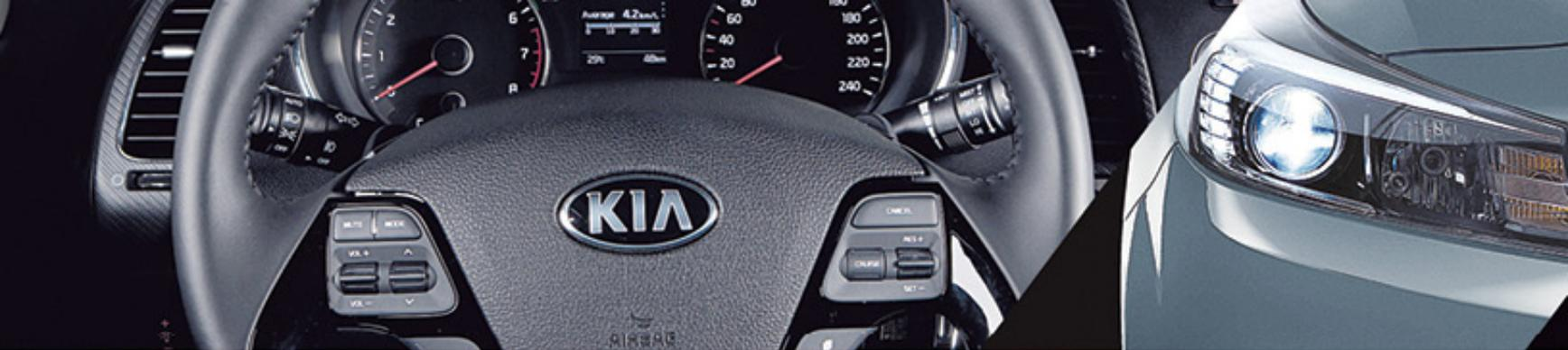
Volante com revestimento de couro, regulagem de altura e profundidade, controles do sistema de som, Bluetooth, piloto automático e computador de bordo.
